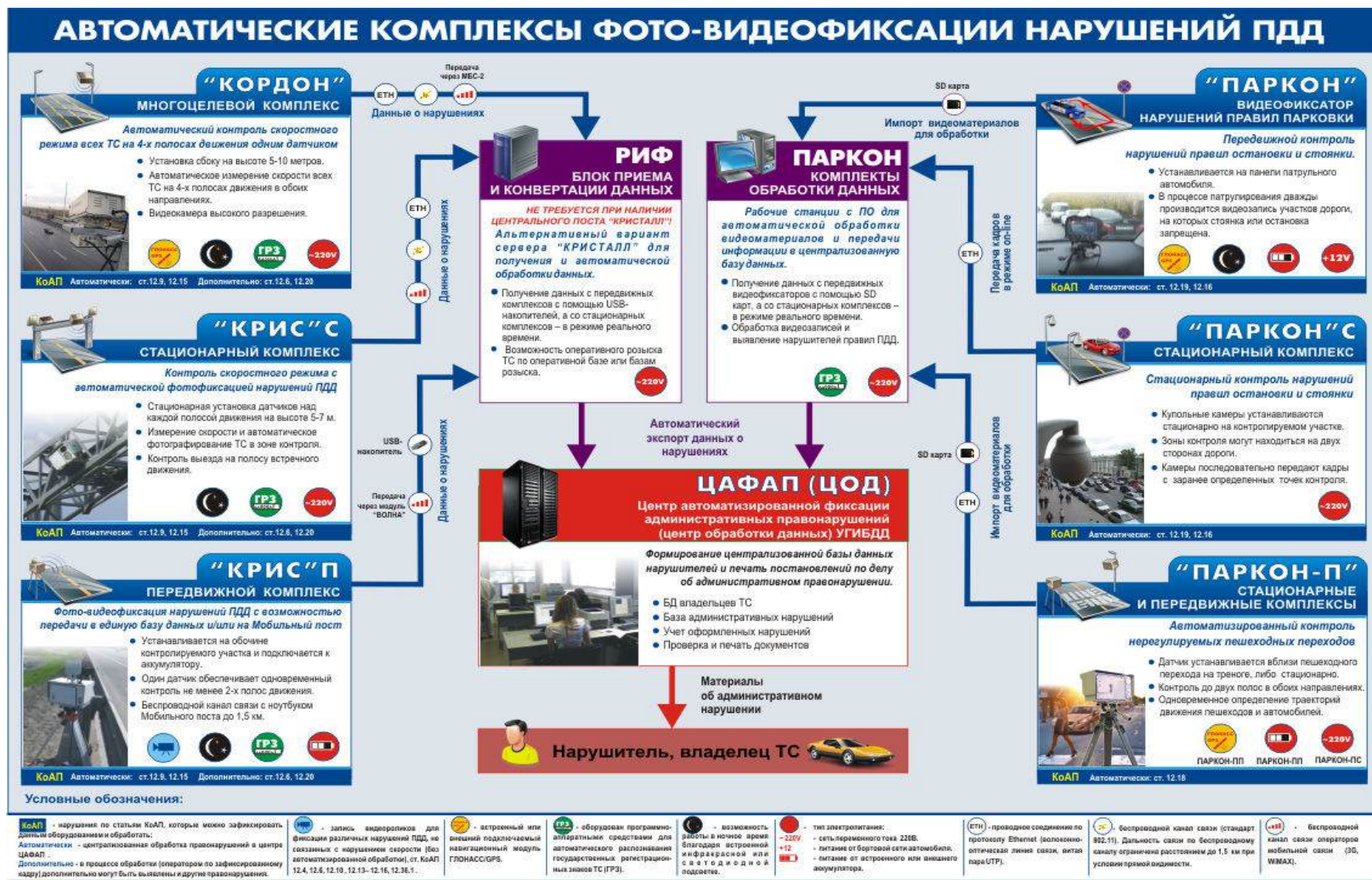
Рисунок 46 – Схема организации автоматических комплексов фото-видеофиксации нарушений ПДД
