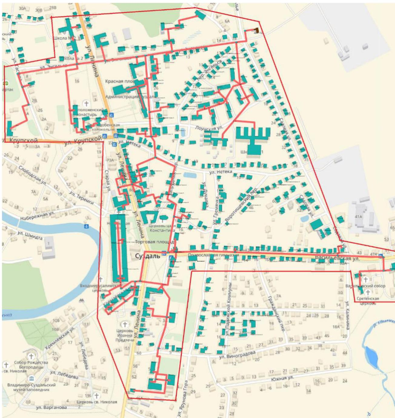
Рисунок 4.9.4 - Схемы тепловых сетей от котельной №2 по адресу: ул. Лесная, д. 2)
