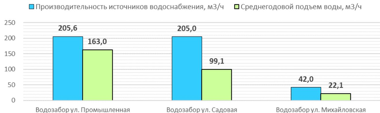
**Рисунок 3.6.1 - Анализ резервов и дефицитов производственных мощностей системы водоснабжения город Суздаль**
