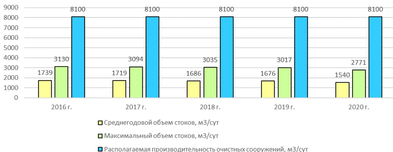
Рисунок 2.4.1 - Динамика резервов/дефицитов производительности очистных сооружений ООО «ВЗС»
