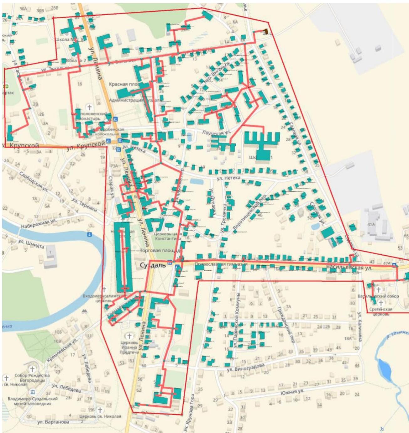
Рисунок 7.2 - Схема теплового района Центрального №2 (Котельная №2 по адресу: ул. Лесная, д. 2)
